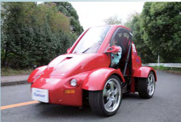
4 輪にダイレクトドライブインホイールモータを搭載した電気自動車
